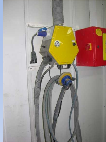
Ponceuse avec aspiration intégrée
