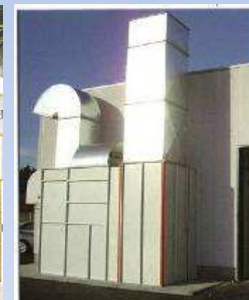
Nouvelle cabine gaz avec recyclage de l'air extrait
